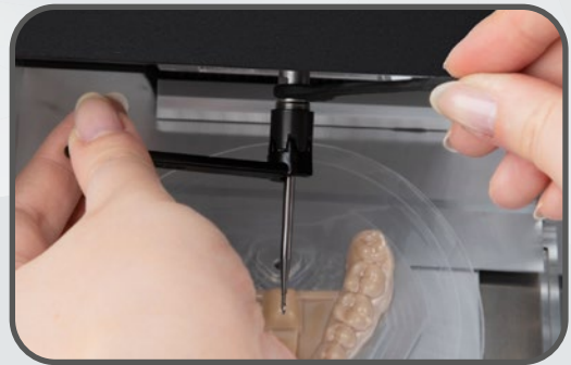
Einfache Montage des Fräasers
