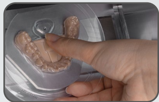
Werkzeugloses Einsetzen des Modells
